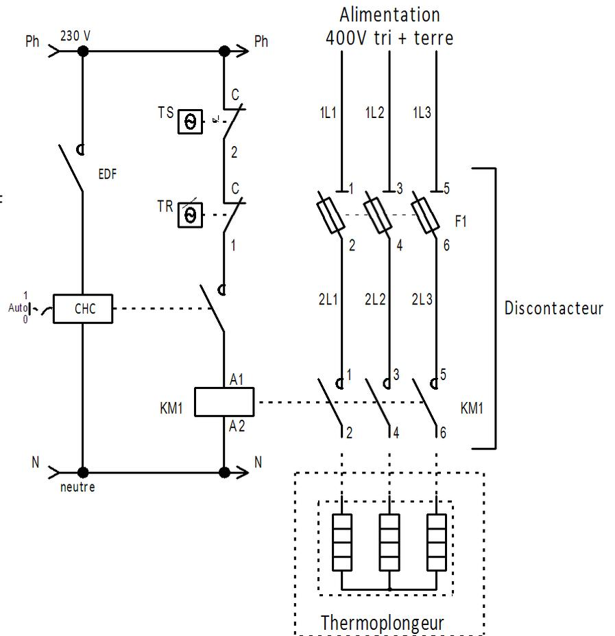
Nota : Dans ce cas ne pas utiliser de contacteur heure creuse jour nuit en triphasé à la place du contacteur KM1 car le thermostat de régulation et/ou de sécurité ne coupera pas l'alimentation du thermoplongeur lorsque le contacteur heure creuse jour nuit sera en marche forcée.
