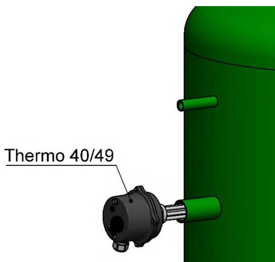
Le thermoplongeur sera monté sur le manchon 40/49 prévu à cet effet.
