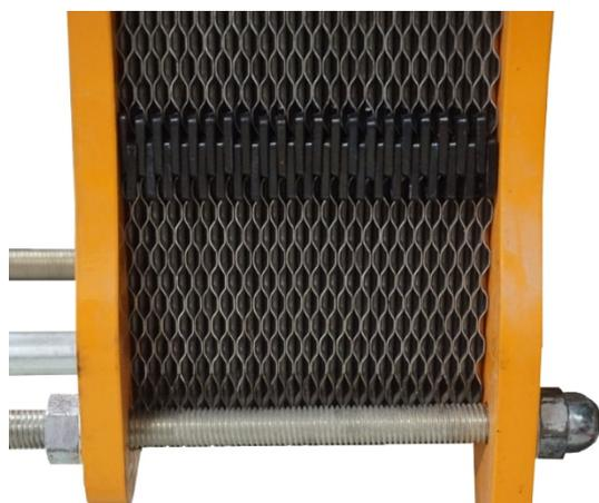
Lorsque l'échangeur est assemblé correctement, l'empilage des plaques forme un "**nid d'abeilles**" et **les clips des joints sont décalés d'une plaque à l'autre.**
