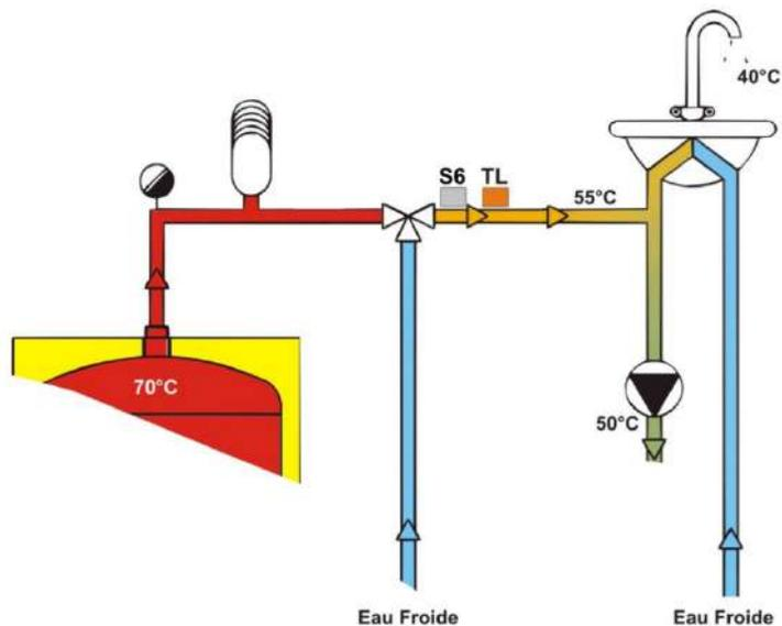
Le régulateur Pack Control 3 permet de piloter une vanne 3 voies ayant une fonction de mitigeur (nécessite le kit sonde pilotage V3V E.C.S.).
