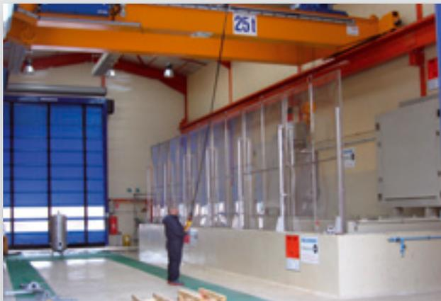
Ce centre est conçu pour décaper par immersion ou par pulvérisation des pièces allant de quelques grammes en série à 20 tonnes à l'unité.
