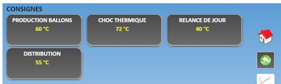
PRODUCTION BALLONS : température de chauffe du ou des ballons.
