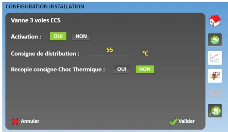
**Recopie consigne Choc Thermique** : si cette option est activée, dès l'enclenchement d'un cycle Choc Thermique, la consigne **Distribution** est remplacée par la consigne **Choc Thermique** pour permettre de traiter le réseau complet. Elle reprend sa valeur initiale dès la fin du cycle Choc Thermique.
