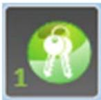
Pour accéder aux fonctions de **l'autorisation 2**, appuyer sur le bouton ci-contre. Un pavé numérique apparaît, entrer le code "**222**" et valider. Le chiffre apparaissant dans l'angle inférieur gauche du bouton indique le niveau d'autorisation atteint.
