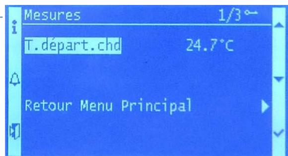
Température de l'eau sortie chaudière.
