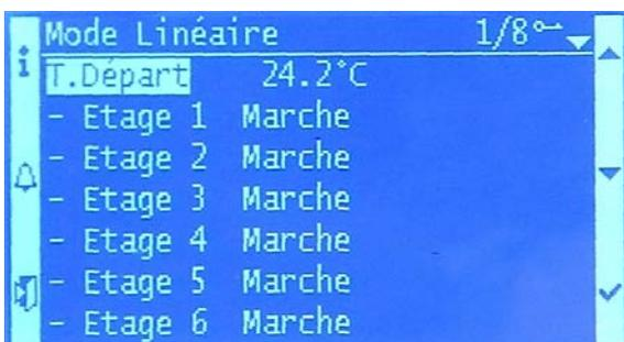
Mode Linéaire : c'est le régulateur qui découpe la bande proportionnelle par le nombre d'étages, déterminant ainsi l'écart entre enclenchement / déclenchement pour chaque étage.
