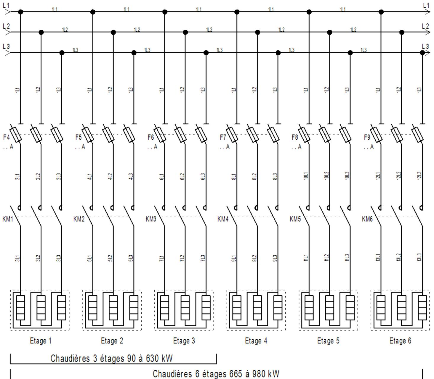
Puissance et protection par étage chaudière 90 à 630 kW
