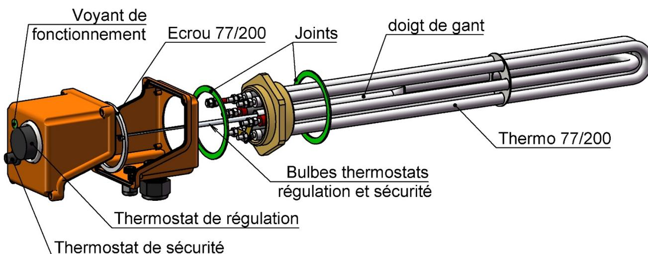
Le thermoplongeur sera monté sur le piquage Ø77/200 prévu à cet effet.
