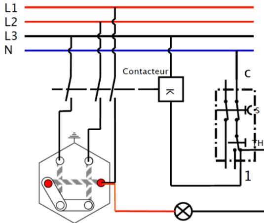
**Thermoplongeurs  $\geq 24$  kW**
