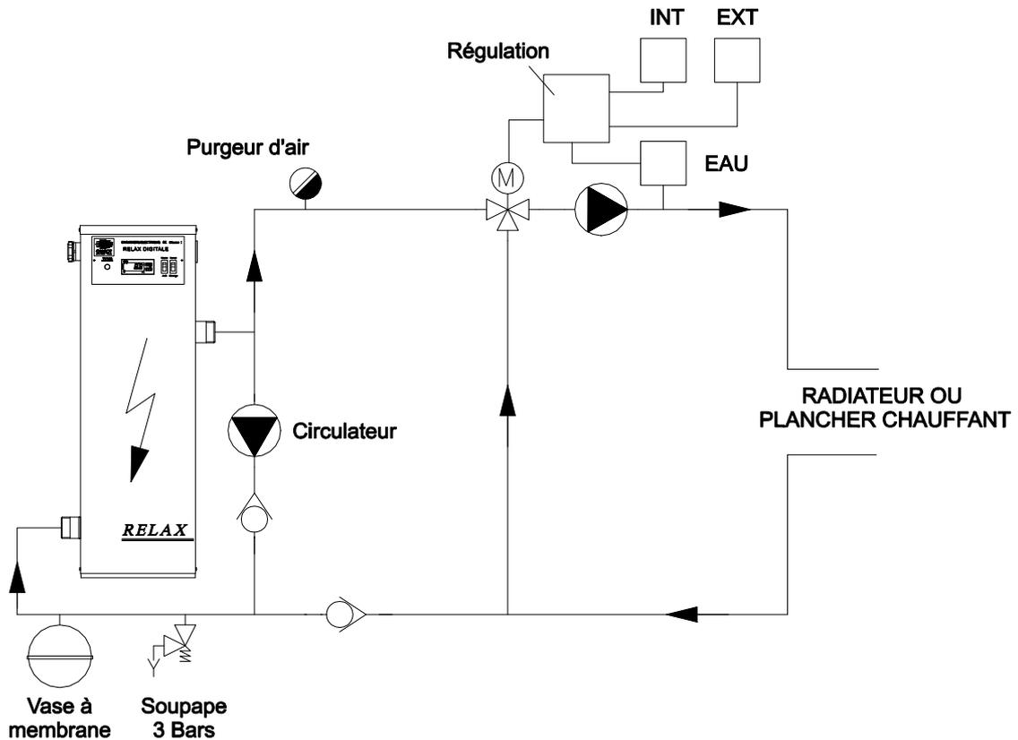
Plancher chauffant : sécurité chaudière 50 °C.
