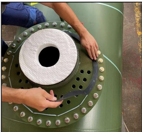
4.2 – Exercer une pression afin de plaquer le joint sur la surface du corps
