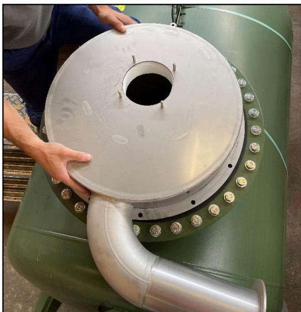
5.2 - Insérer les vis de fixation
