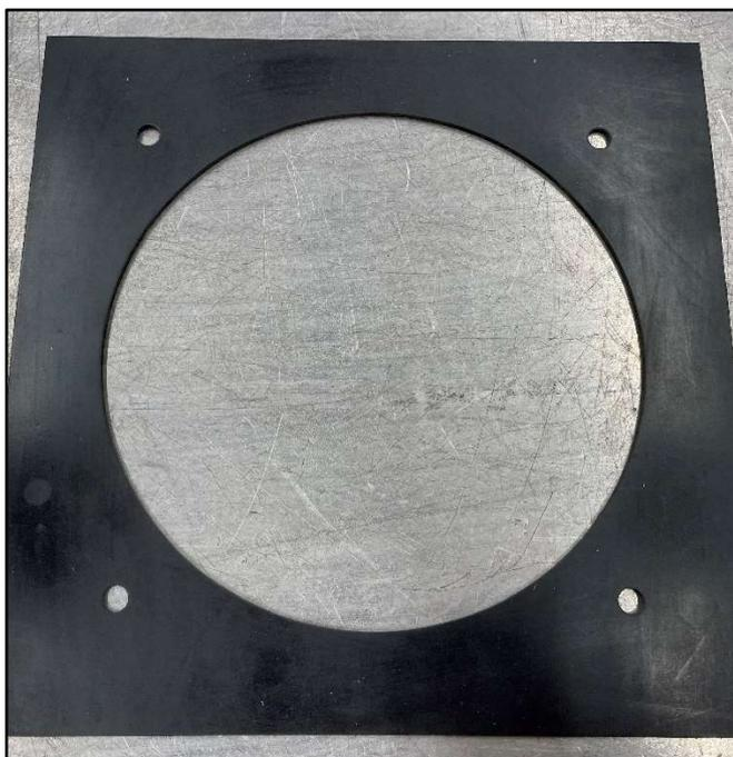
5.2 - Repositionner la plaque foyère et procéder à sa fixation (4 vis de 8)
