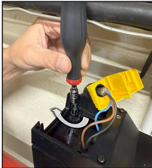
7.8 - Visser les 4 vis du capot intermédiaire
