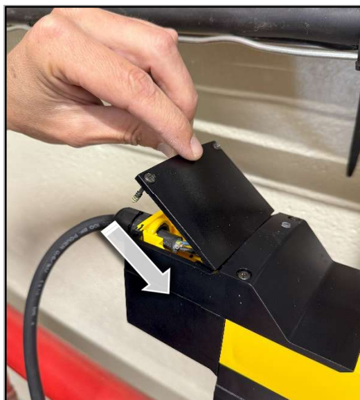
7.10 - Emboîter le capot de protection dans le capot intermédiaire
